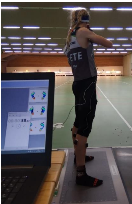
Рисунок 1 – Фрагмент тестирования биатлонной стрельбы с помощью педобарографической платформы «SB-Mat»
