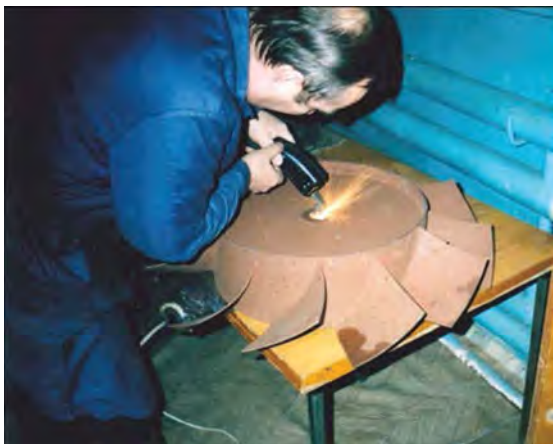
Рис. 7. Восстановление посадочных мест промышленных вентиляторов
