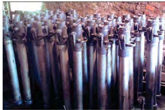
Рис. 6. Шахтные гидростойки после восстановления методом электроискрового легирования
