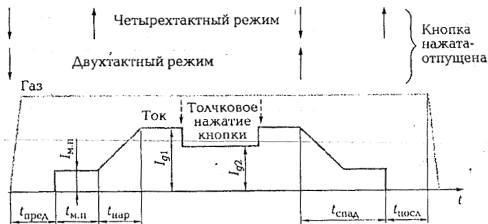
Рис. 1.9. Циклограмма аргодуговой сварки
