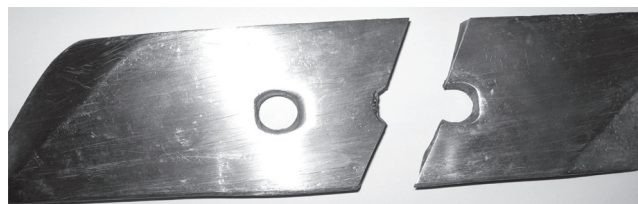
Рис. 3. Излом обратного долота по концентраторам напряжений
