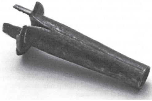
Рис. 3. Брак при штамповке горелок в результате предварительного дорекристаллизационного отжига (СП ОАО «Брестгазоаппарат», г. Брест)
