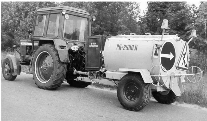
Рис. 4.34. Машина для ремонта дорожных покрытий РД–2500 Л
