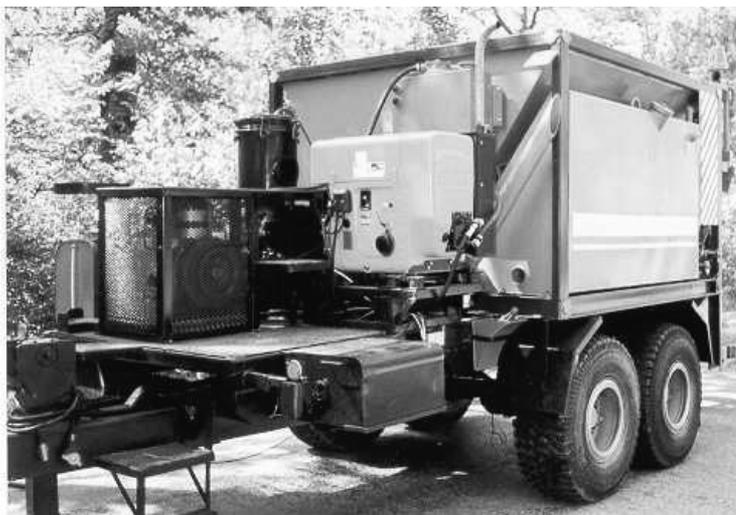
Рис. 4.52. Универсальная машина для ямочного ремонта асфальтобетонных покрытий автомобильных дорог ФСИТ-42
