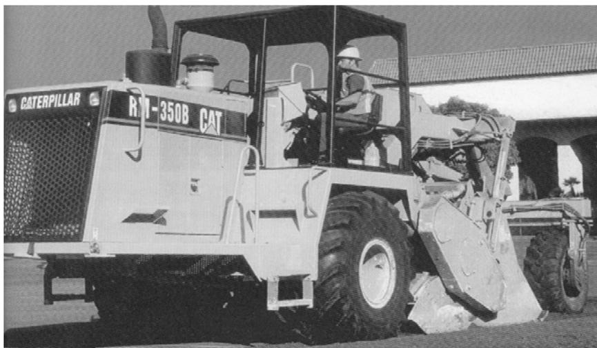
Рис. 4.110. Рециклер фирмы «CATERPILLAR» (США)
