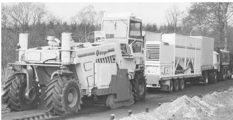
Рис. 4.129. Установка WM 400 фирмы «Wirtgen» (Германия), агрегируемая с рециклером при производстве технологического процесса холодного рециклинга покрытий автомобильных дорог
