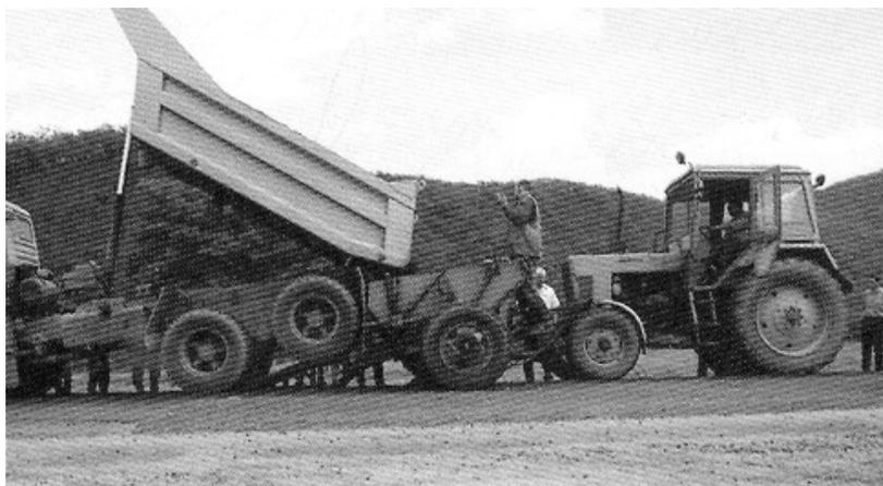
Рис. 4.74. Щебнераспределитель Т-224 производства Мамонтовского опытно-экспериментального завода (Московская область)
