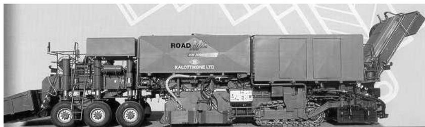
Рис. 4.98. Ремиксеры Road Mix моделей KM 2000 RS и KM 3000 RS фирмы «KALOTTIKONE LTD» (Финляндия) для выполнения технологического процесса горячего рециклинга
