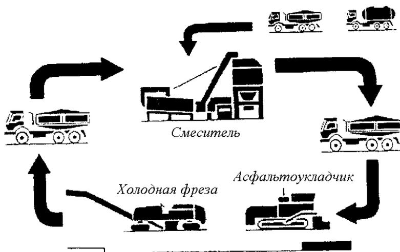
Рис. 4.84. Схема технологического процесса горячего рециклинга на заводе
