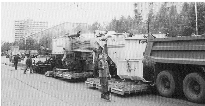
Рис. 4.96. Ремиксер Wirtgen 4500 (Германия) для выполнения технологического процесса горячего рециклинга
