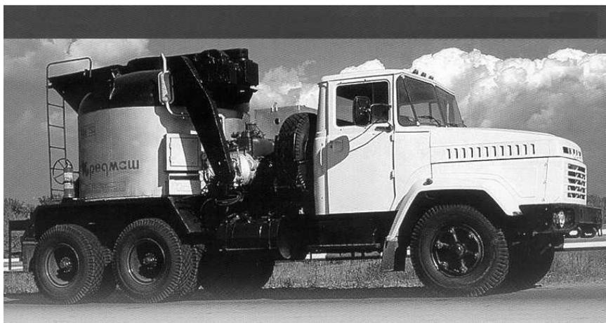
Рис. 4.35. Котел для литого асфальта КДМ–150 производства ОАО «Кременчугский завод дорожных машин» (Украина)
