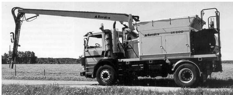
Рис. 4.47. Машина для ямочного ремонта асфальтобетонных покрытий автодорог SR 800 фирмы «SAVALCO» (Швеция)
