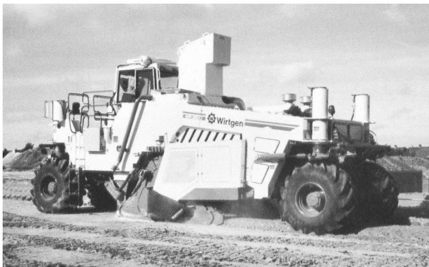
Рис. 4.115. Рециклер WR 2500 К фирмы «Wirtgen» (Германия)
