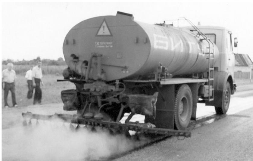
Рис. 4.67. Автогудронатор АРБ–7 на шасси МАЗ–5337 производства Фанипольского опытно-механического завода
