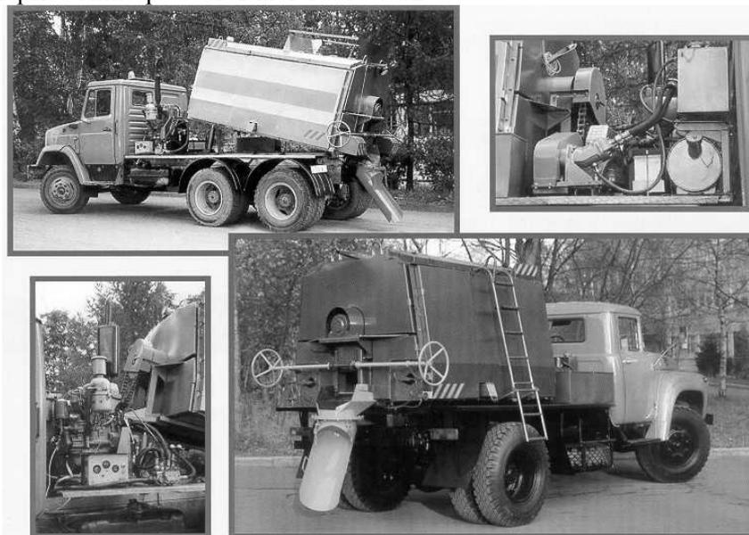
Рис. 4.32. Термос-миксеры производства ЗАО «Асфальттехмаш» и ЗАО «Бецема»
