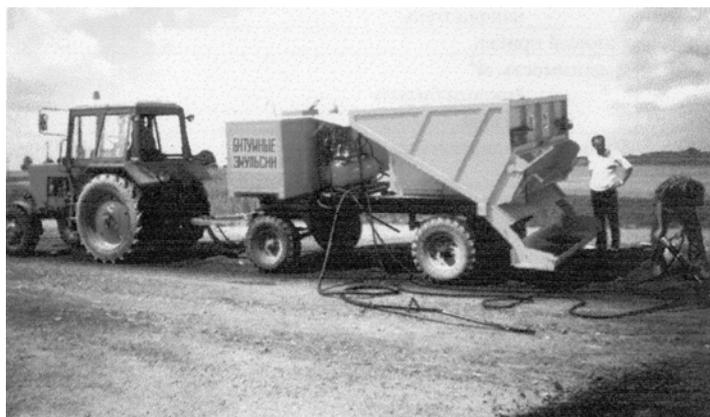
Рис. 4.38. Установка для ямочного ремонта УДВ–2000 производства ГП «Дорвектор» (г. Молодечно)
