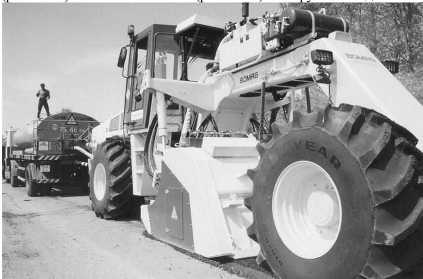
Рис. 4.107. Рециклер МРН 120 фирмы «BOMAG» (Германия)
