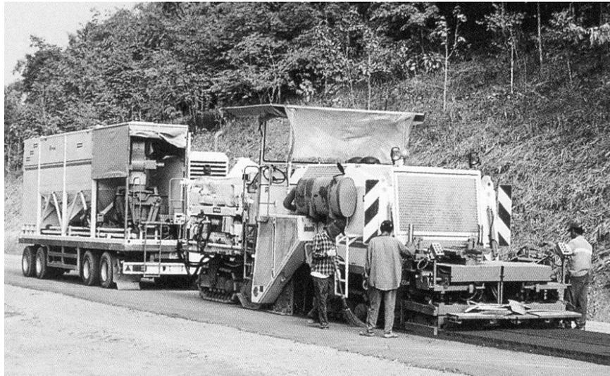
Рис. 4.112. Рециклер 2100 DCR фирмы «Wirtgen» (Германия)
