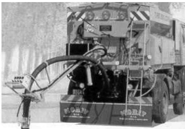
Рис. 4.51. Машина для ямочного ремонта асфальтобетонных покрытий автодорог TURBO-COMBI модификации 4000-7000 фирмы «КОВИТ» (Чехия)
