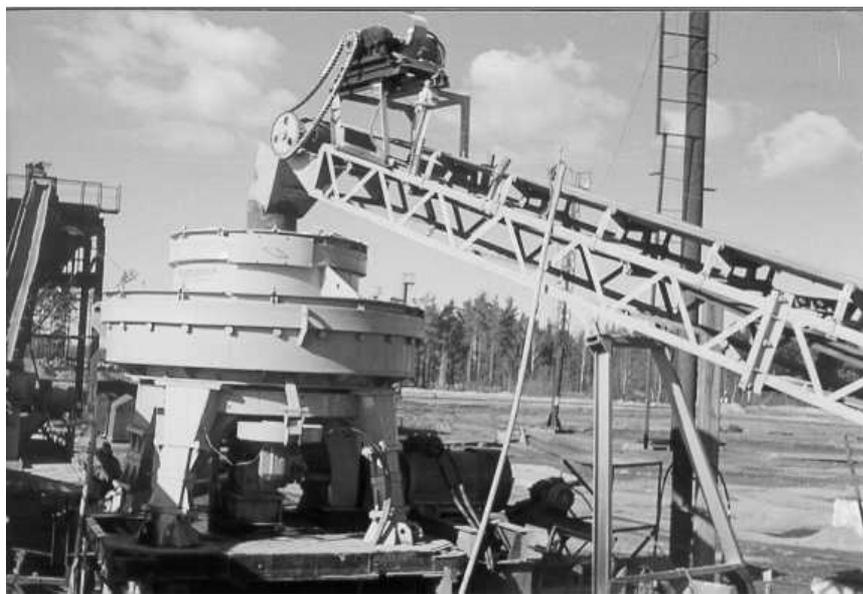
Рис. 4.12. Дробилка центробежная ДЦ – 1.6 разработки и производства НПО «Центр» (г. Минск)
