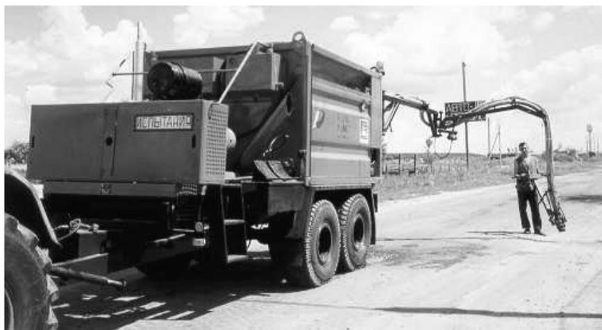
Рис. 4.53. Машина для ямочного ремонта Р-310 производства ООО «Радицкий машиностроительный завод» (г. Брянск)
