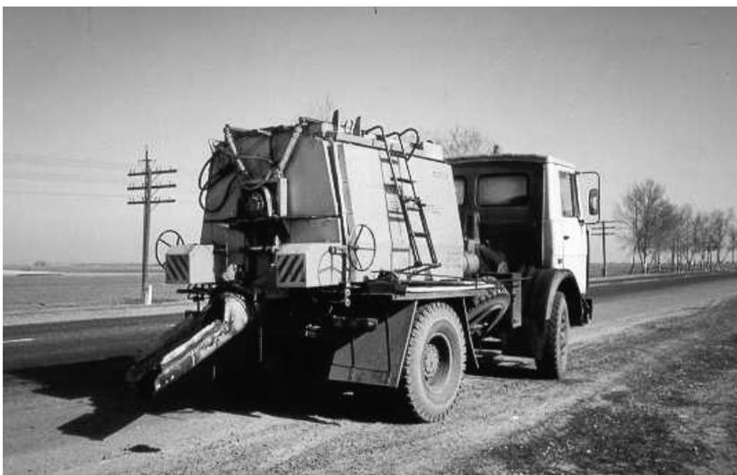
Рис. 4.33. Термос-миксер ФСИТ-39 производства Гомельского завода «Стромавтолиния»
