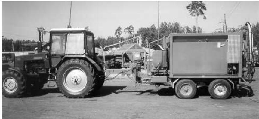
Рис. 4.49. Установка BLOW-PATCHER для ямочного ремонта асфальтобетонных покрытий автодорог фирмы «SCHAFER» (Германия)
