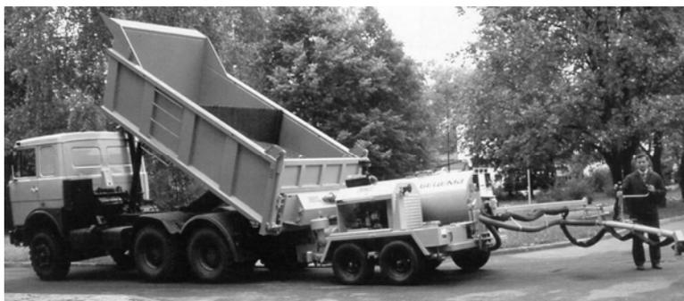
Рис. 4.45. Установка для ямочного ремонта БЦМ–24 производства ЗАО «Бецема» (г. Красногорск)
