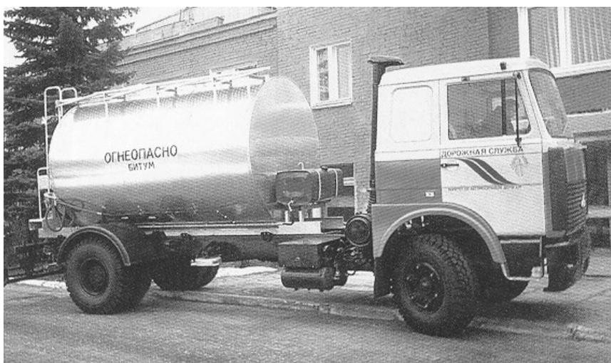
Рис. 4.68. Автогудронатор АРБ–8 на шасси МАЗ–5336–040 производства Фанипольского опытно-механического завода
