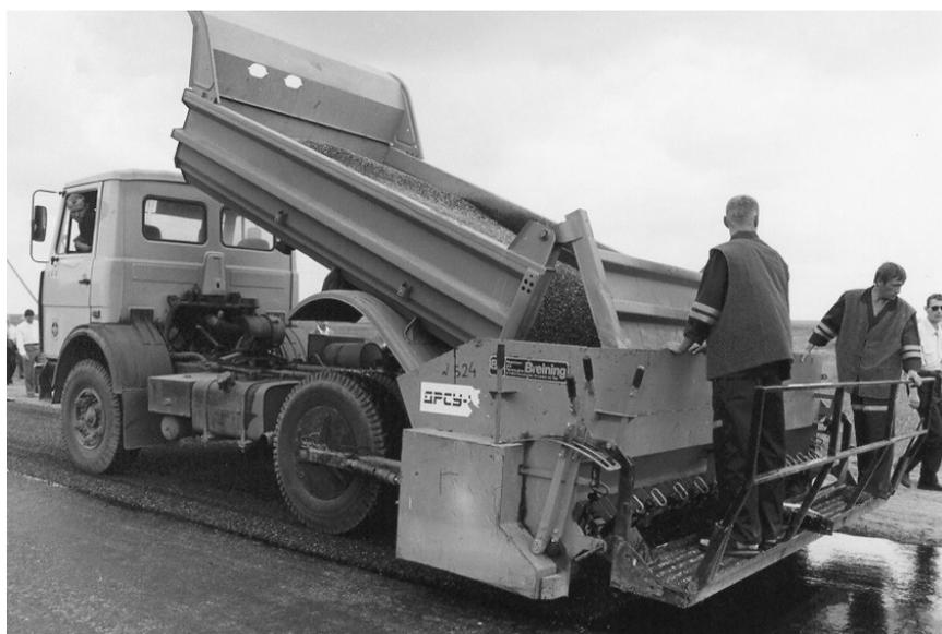
Рис. 4.70. Щебнераспределитель ЩРД–3.5 производства ГП «Дорвектор» (г. Молодечно)
