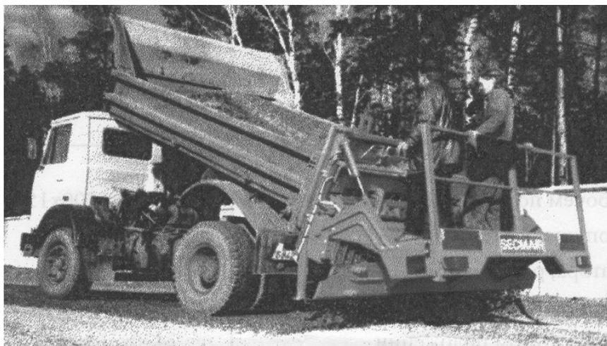
Рис. 4.69. Щебнераспределитель ЩРДС-1400 (ЩРД-1400) производства ГП «Дорвектор» (г. Молодечно)
