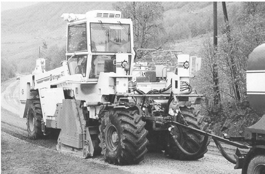
Рис. 4.114. Рециклер WR 2500 фирмы «Wirtgen» (Германия)
