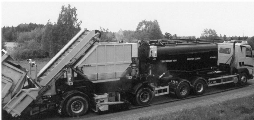
Рис. 4.79. Ремонтный поезд фирмы «SAVALCO» модели H110T COMBI TELESPRAY 480
