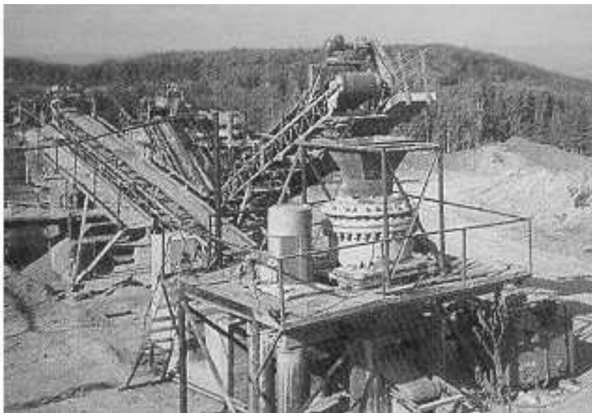
Рис. 4.8. Конусная инерционная дробилка КИД-1200 производства АО «Механобр–Техника» (г. Санкт-Петербург)
