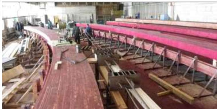
Рис. 2. Испытание полуарки стрельчатого очертания на заводском стенде
