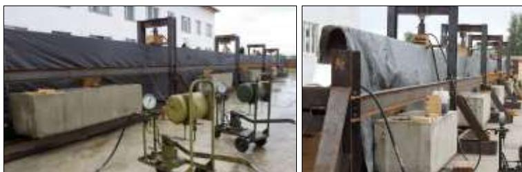
Рис. 7. Фрагмент нагружения клееных балок в испытательной установке
