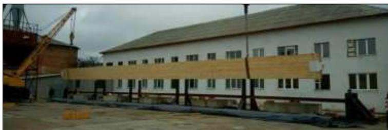
Рис. 6. Монтаж деревянной балки в испытательный стенд
