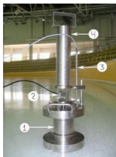
Рисунок 2 – Общий вид прибора для определения твердости льда
