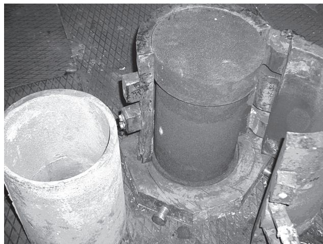
Рис. 2. Чугунный кокиль с земляным стержнем и бронзовый расходуемый электрод
