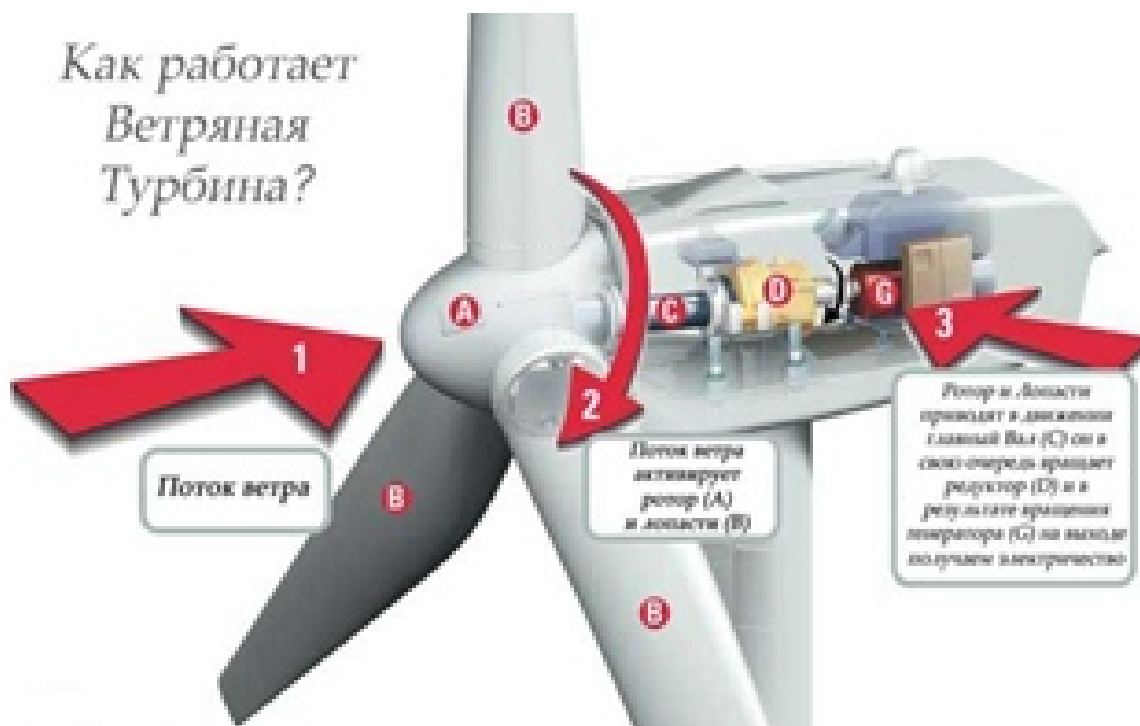
Рисунок 4 – Принцип действия ветряной турбины
