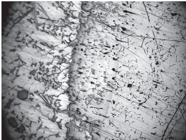
Рис. 2. Зона контакта «поршневой сплав-вставка под верхнее поршневое кольцо» с образованием переходного диффузионного слоя. Травлено 0,5% HF. \times 240
