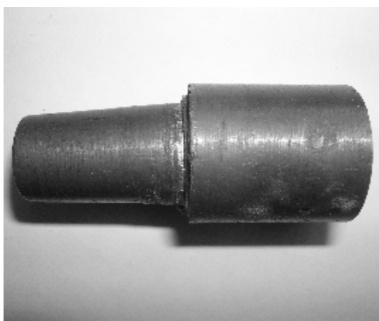
Рисунок 4 — ЭКС, восстановленный разработанными сплавами
