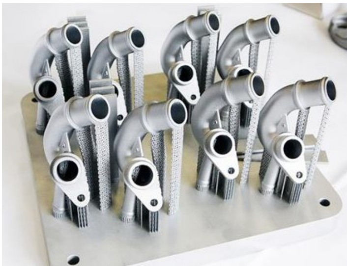
Рисунок 4- Металлические 3D-печатные коннекторы системы охлаждения двигателя AUDI W12.
