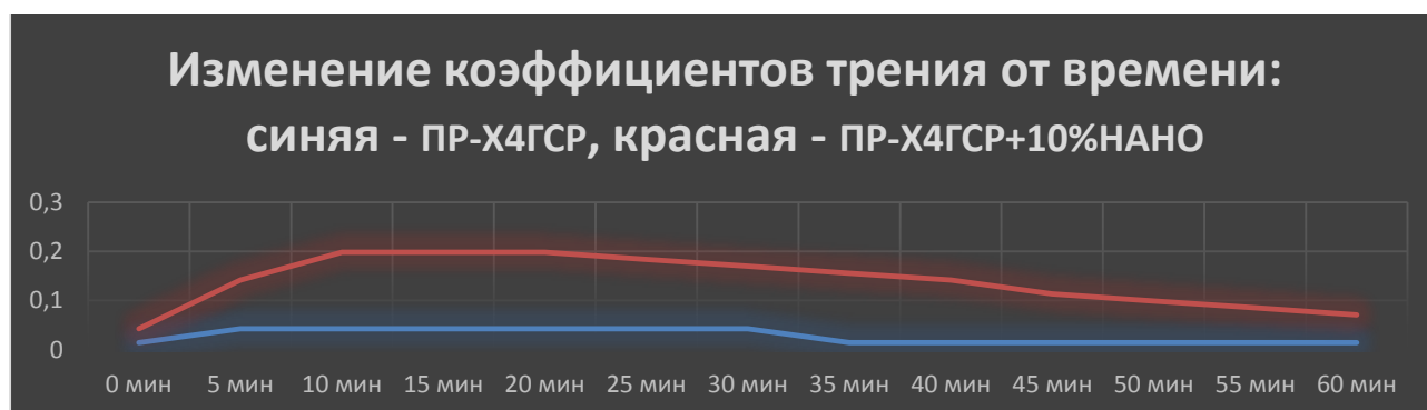
Рисунок 1 – График изменения коэффициентов трения в течении времени образцов ПР-Х4ГСП и ПР-Х4ГСП+10 % НАНО
