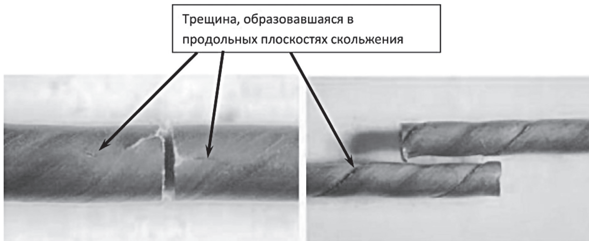
Рис. 6. Образцы проволоки с продольно-ориентированной трещиной и ровным основным изломом после разрушения (образцы с нестабильными характеристиками числа скручиваний до разрушения)
