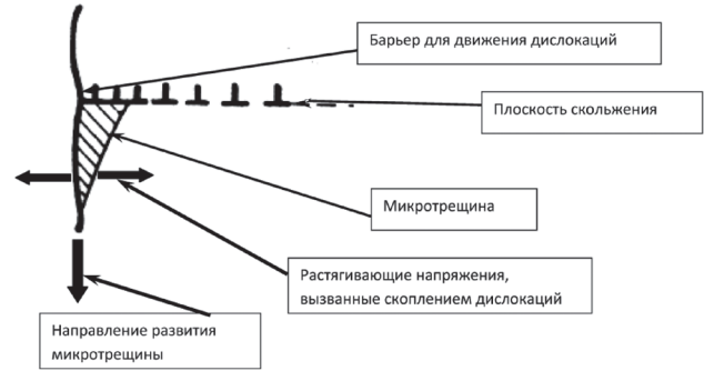
Рис. 3. Схема зарождения трещины у вершины дислокационного скопления
