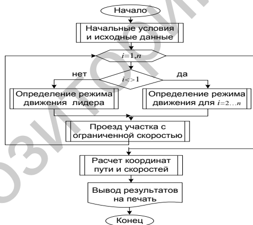
Рисунок 3 – Общая блок-схема алгоритма моделирования движения ТП на дорогах с участками ограничения скорости
