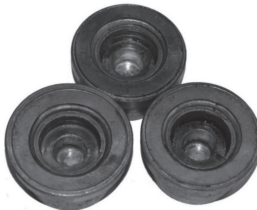
Рис. 2. Заготовки деталей «Направляющая штока», полученных методом объемной штамповки
