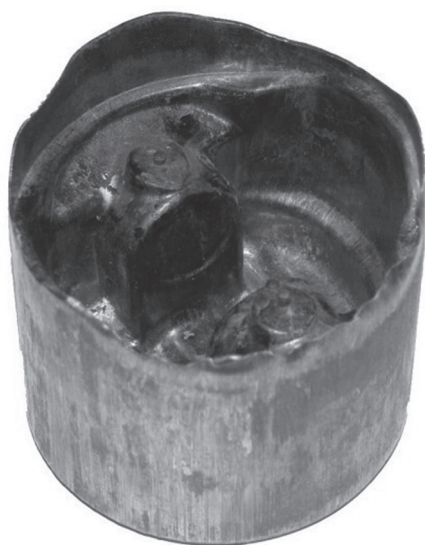
Рис. 3. Заготовка поршня, полученная методом изотермического прессования
