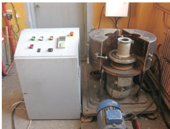
Рисунок 4 – Общий вид установки вертикального центробежного литья
