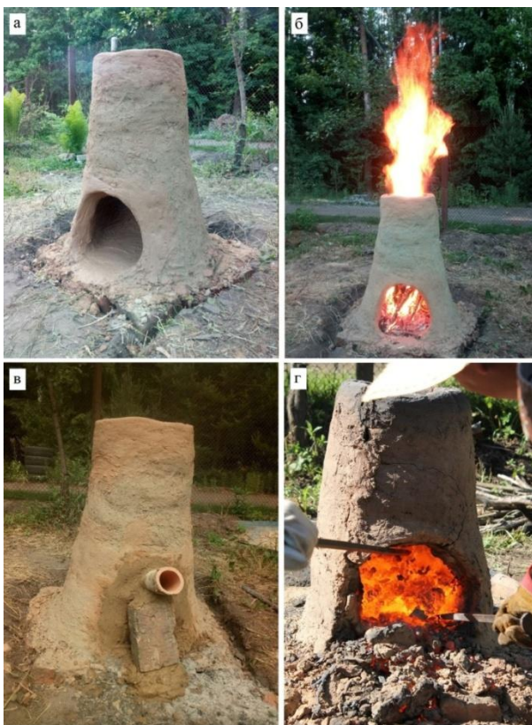
а – внешний вид домницы для второго эксперимента; б – сушка печи перед эксплуатацией; в – домница с установленной фурмой; г – выемка продуктов металлургического процесса
