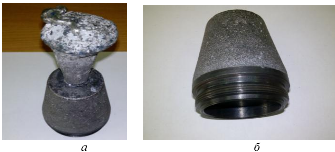
Рисунок 1 – Отливка (а) полученная в разовой литейной форме и готовый катод-мишень с тоководом (б) [2]
