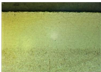
Рисунок 1 – Микроструктура термодиффузионного азотированного слоя на стали 4X5MFC после стационарного насыщения 600 °С, 8 ч
