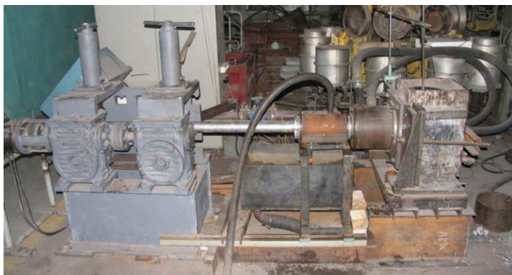
Рисунок 3 – Общий вид установки непрерывного горизонтального литья
