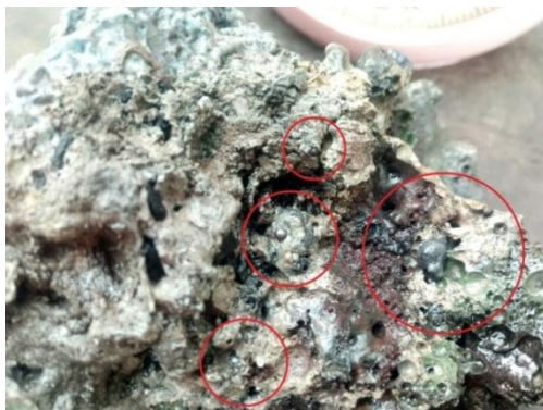
Рисунок 1 – Конкреции металлического железа в шлаке (зоны их образования обведены кругом)
