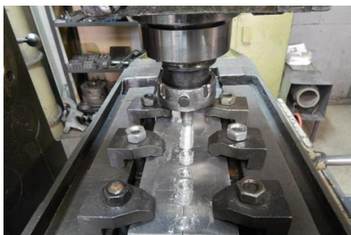
Рисунок 2 – Технологическая схема сварки образцов (вдоль) из листовых материалов на столе фрезерного станка
