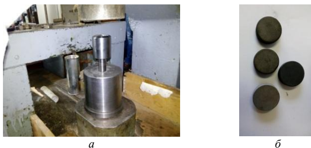
а Рисунок 3 – Технологическая оснастка для отработки режимов деформации порошка комплексного силицида ( а ) и опытный образец полученного брикета ( б )
