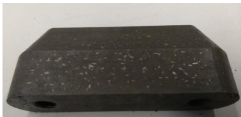
Рисунок 1 – Внешний вид участков разрушения борированного изделия (керна) за счет термических и структурных напряжений
