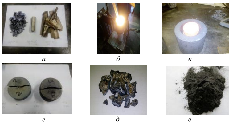
а – металлическая шихта (кремний, никель, титан); б – высокоскоростная индукционная плавка; в – полученный слиток; г – после охлаждения; д – после дробления; е – после размола
