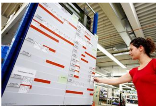
Рис. 1.3.7. Применение KANBAN-доски в реальном производстве
