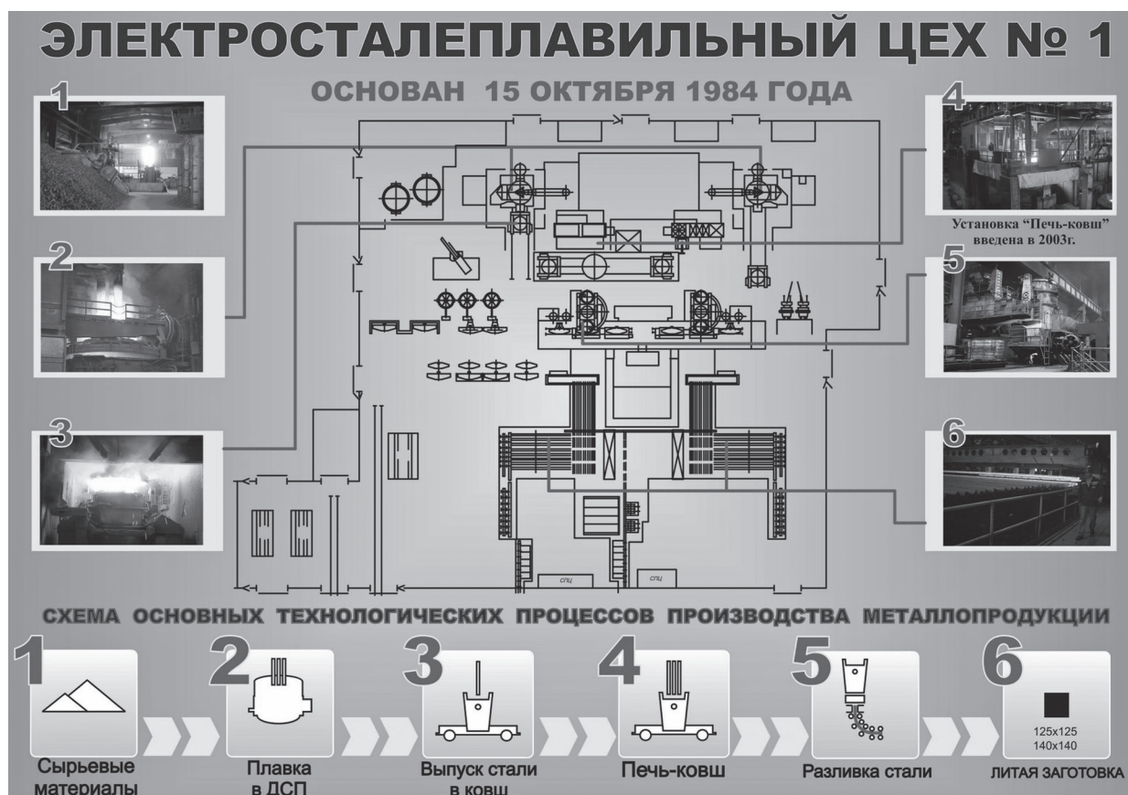
Рис. 1. Технологическая схема сталеплавильного цеха № 1
