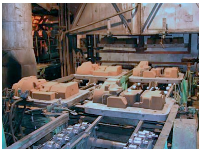
Рис. 1. Половинки стержней отливки «корпус муфты сцепления», изготавливаемые по технологии тепловой сушки
