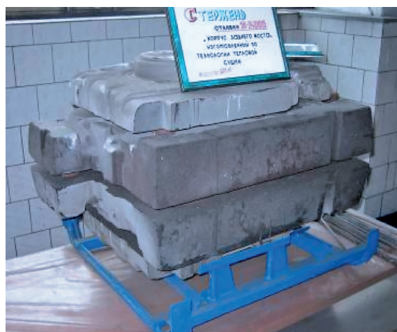
Рис. 2. Комплект стержней отливки «корпус заднего моста», изготовленных по технологии тепловой сушки
