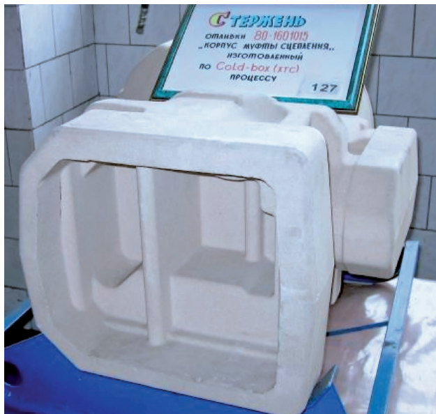
Рис. 5. Целиковый стержень отливки «корпус муфты сцепления 80-1601015», изготовленный по Амин-процессу
