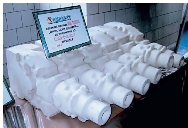
Рис. 7. Комплект пустотелых цилиндракартерных стержней отливки «корпус шестицилиндрового блока цилиндров», изготовленный по Амин-процессу
