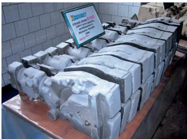
Рис. 3. Комплект цилиндрокартерных стержней отливки «корпус 6-цилиндрового блока цилиндров», изготовленный по технологии тепловой сушки
