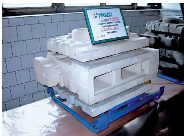
Рис. 4. Комплект стержней отливки «корпус заднего моста», изготовленных по Амин-процессу с объединением двух стержней в единый и опустошением
