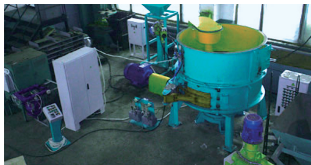
Рис. 5. Отладка автоматизированного смесеприготовительного комплекса мод. 4847
