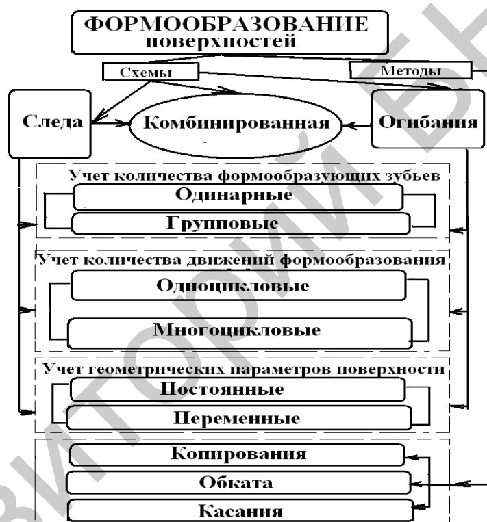
Рисунок 1 – Структура формообразования топографии поверхностей
