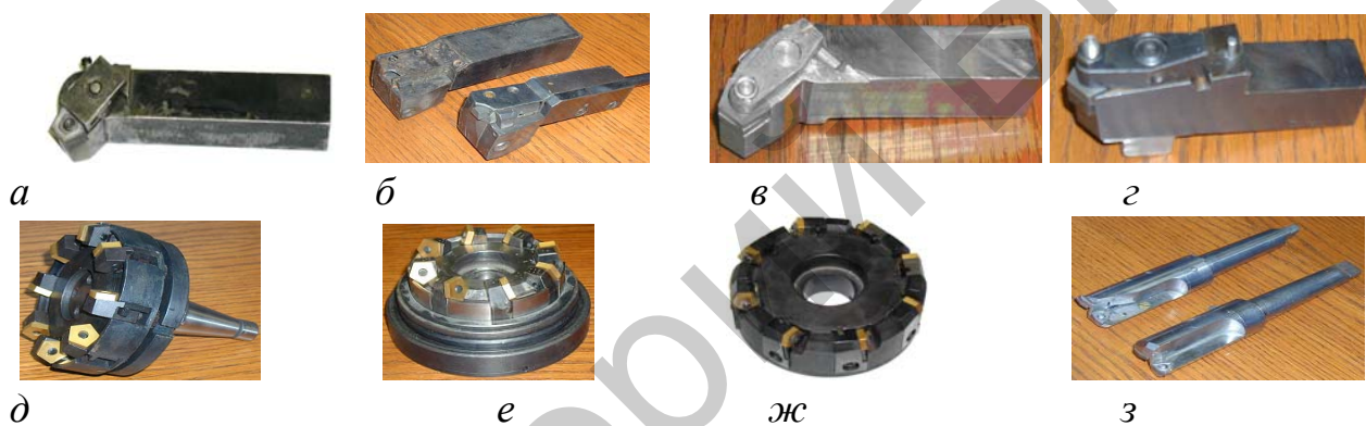
Рисунок 15 – Фотографии инструментов с автоматической сменой режущих кромок: а – г – резцы; д – ж – торцовые фрезы; з – сверла
