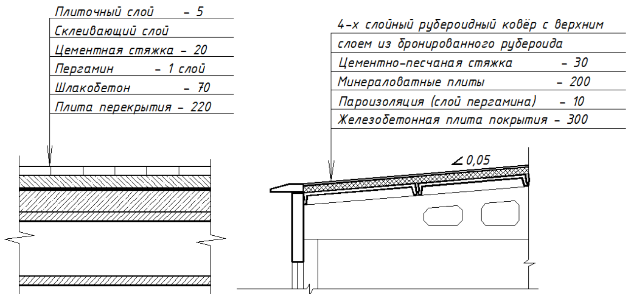
Рис.9.12. Примеры выполнения выносных надписей к многослойным конструкциям а) конструкция пола на перекрытии жилого дома; б) конструкция кровли промышленного здания
