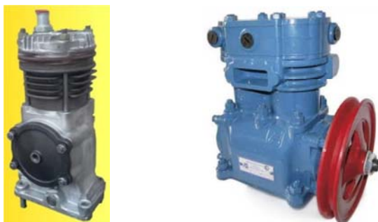
Рис. 1.1. Общий вид одноцилиндрового (МТЗ) и двухцилиндрового (МАЗ) компрессоров
