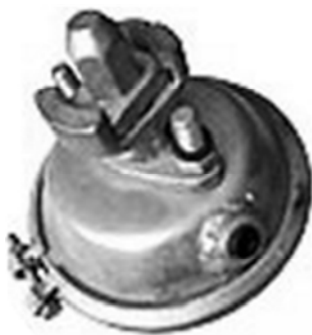
Рис. 2.2. Общий вид пневмопереходника
