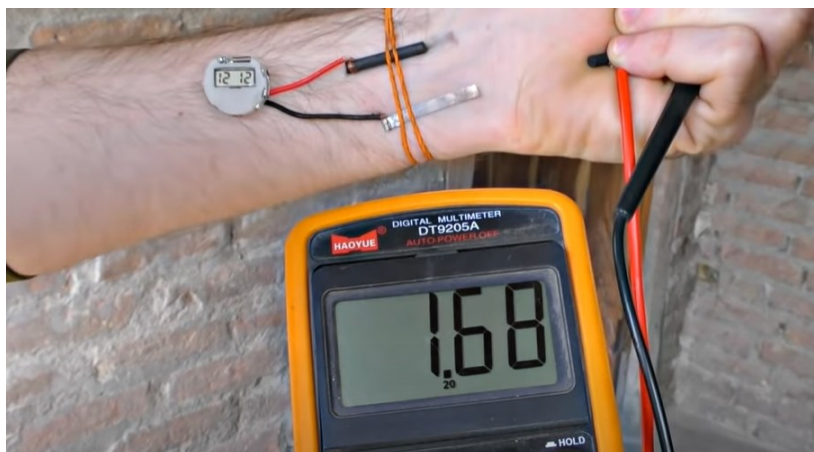
Рисунок 3. Работа часов при присоединенной гальванической пары к ним
