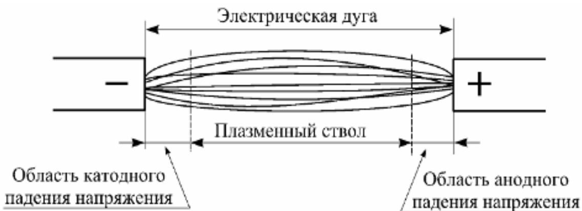
Рисунок 1. Строение электрической дуги
