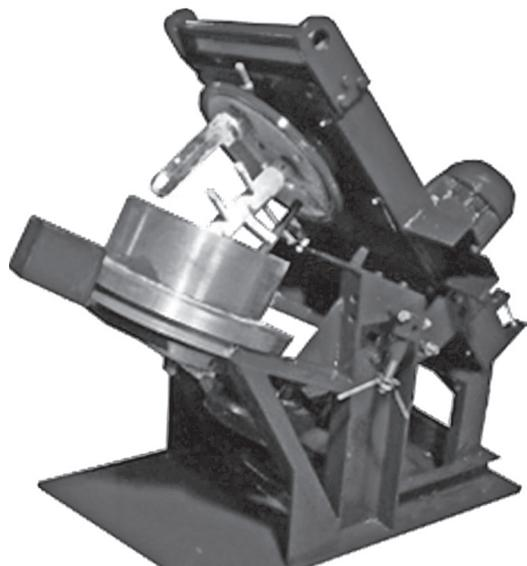
Рис. 12. Смеситель «СИД50» интенсивного действия
