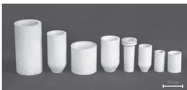
Вибролитые тигли из ZrO_2 производства ПАО «УКРНИИО им. А. С. Бережного»
