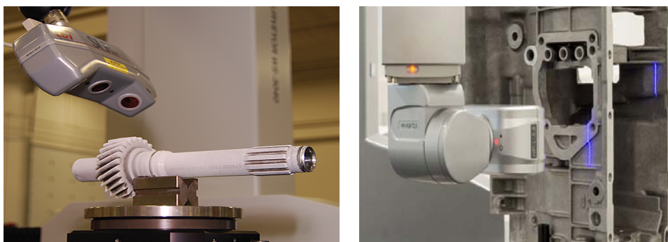
Рисунок 3 – Лазерное 3D-сканирование сложнопрофильных изделий
