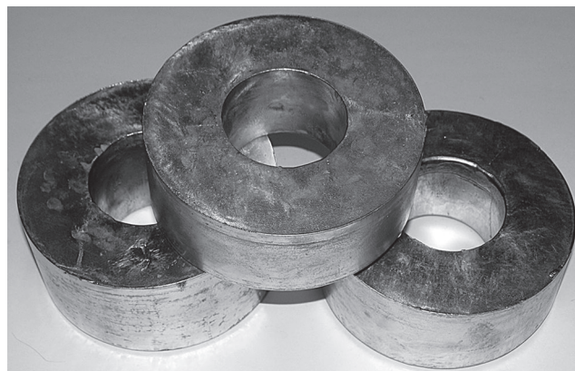
Рис. 2. Отливки диаметром 150 мм из сплава АК12, полученные намораживанием на стальном водоохлаждаемом стержне
