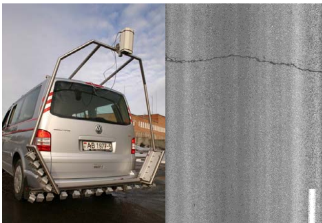
Рис. 7.1. Установка сканирования дефектов
