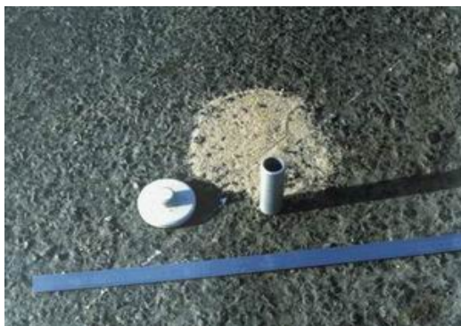
Рис. 6.4. Инструмент для измерения методом «песчаное пятно»
