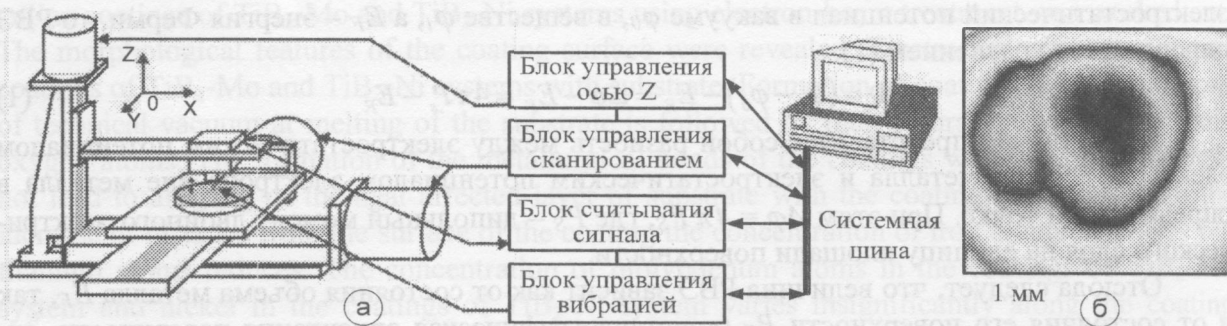
Рис. 2. Структурная схема экспериментальной установки (а), топология работы выхода электрона при точечном нагружении
