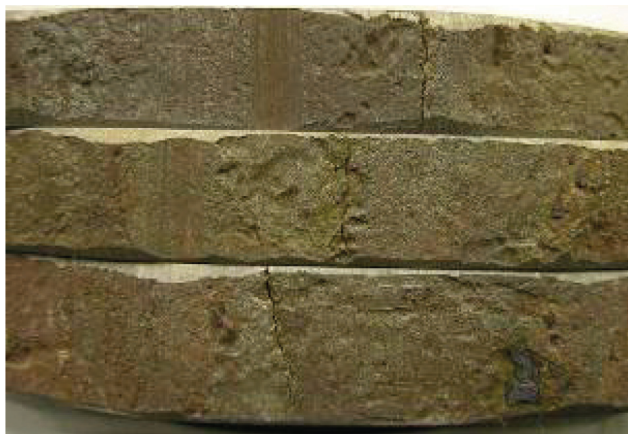
Рис.4. Внешний вид трещин на поверхности непрерывнолитых заготовок диаметром 200 мм
