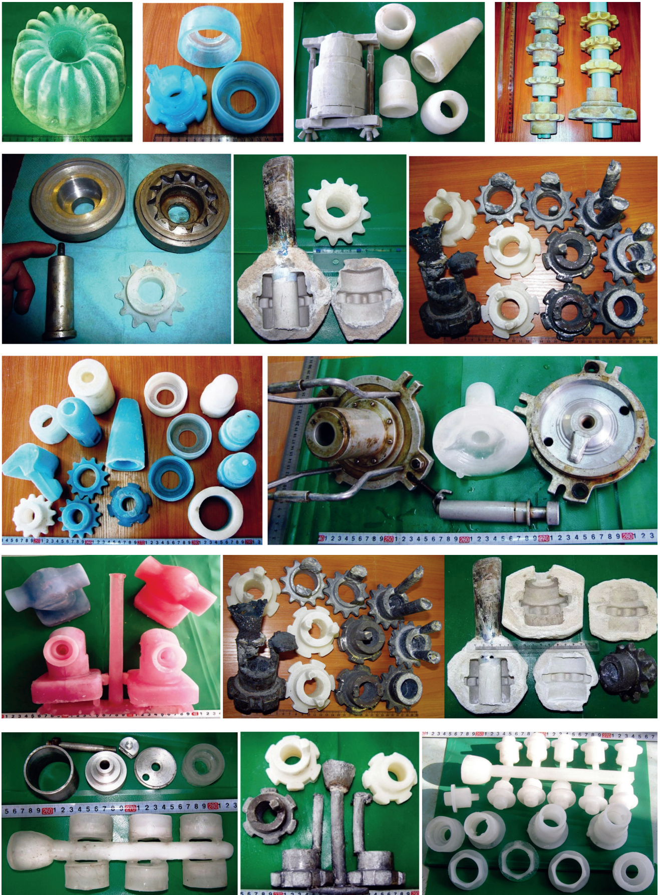
Ледяные модели, песчаные оболочки, отливки из черных и цветных металлов по ледяным моделям
