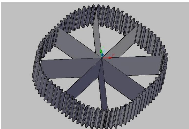
Рисунок 4 – 3D-визуализация зубчатого профиля ведомого колеса
