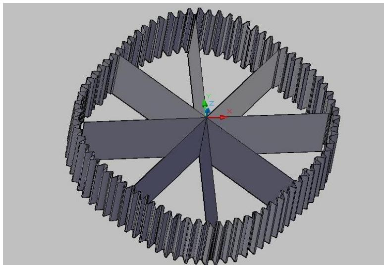
Рисунок 4 – 3D-визуализация зубчатого профиля ведомого колеса
