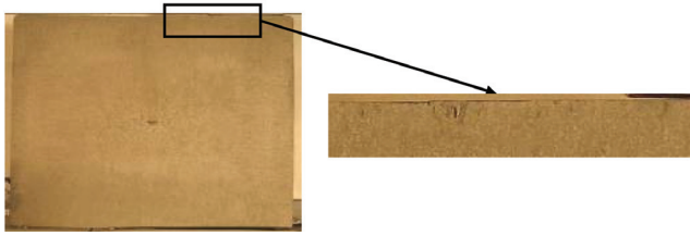
Рис. 2. Макроструктура поперечного сечения (300×400 мм) непрерывнолитой заготовки из стали марки S355J2
