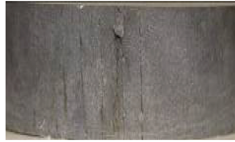
Рис. 3. Внешний вид трещин на поверхности горячекатаной заготовки из стали марки S355J2
