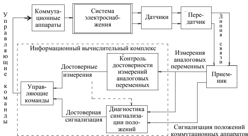
Рис. 1. Схема основных информационных потоков в системе измерений, сбора и обработки измерительной информации
