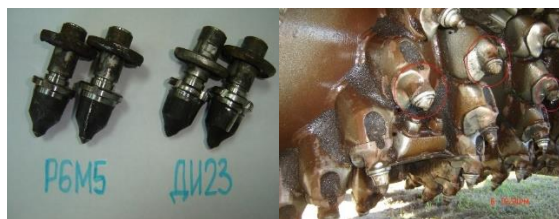
Рис. 2. Фото образцов биметаллических резцов для дорожных машин до испытания и после испытания на автодорогах РБ
