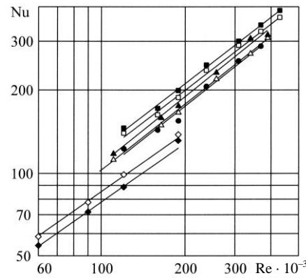
Рис. 2. Зависимость числа Nu от числа Re при различных значениях  $\tilde{f}_{bx1}$ :
