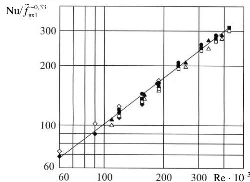
Рис. 3. Средняя теплоотдача на поверхности круглого цилиндра
