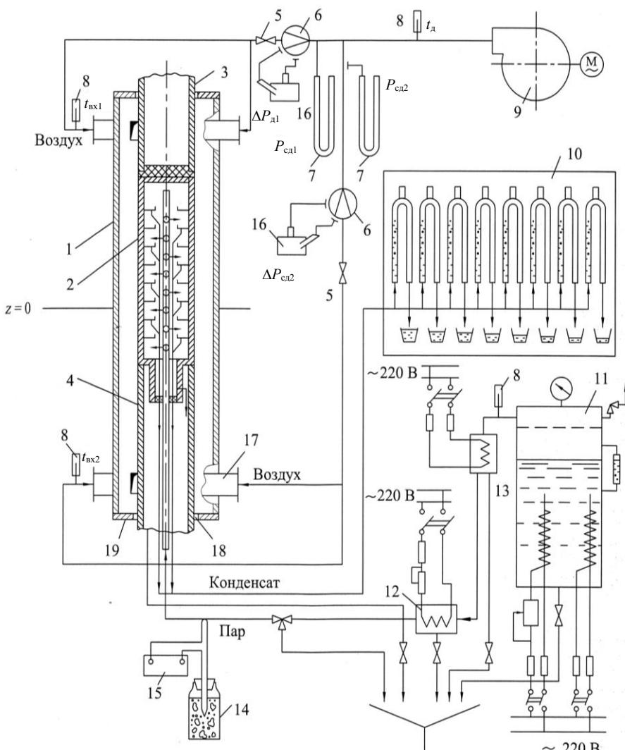
Рис. 1. Схема экспериментального стенда: 1 – циклонная камера; 2 – цилиндр-калориметр; 3, 4 – секция удлинительная, охранная; 5 – заслонка; 6 – нормальное сужающее устройство; 7 – У-образный манометр; 8 – термометр; 9 – воздуходувка; 10 – щит с гидрозатворами; 11 – паровой электрокотел; 12, 13 – пароперегреватель основной и дополнительный; 14 – сосуд с тающим льдом; 15 – потенциометр; 16 – микроманометр; 17 – тангенциальная шлифа; 18 – выходное отверстие; 19 – плоский пережим
