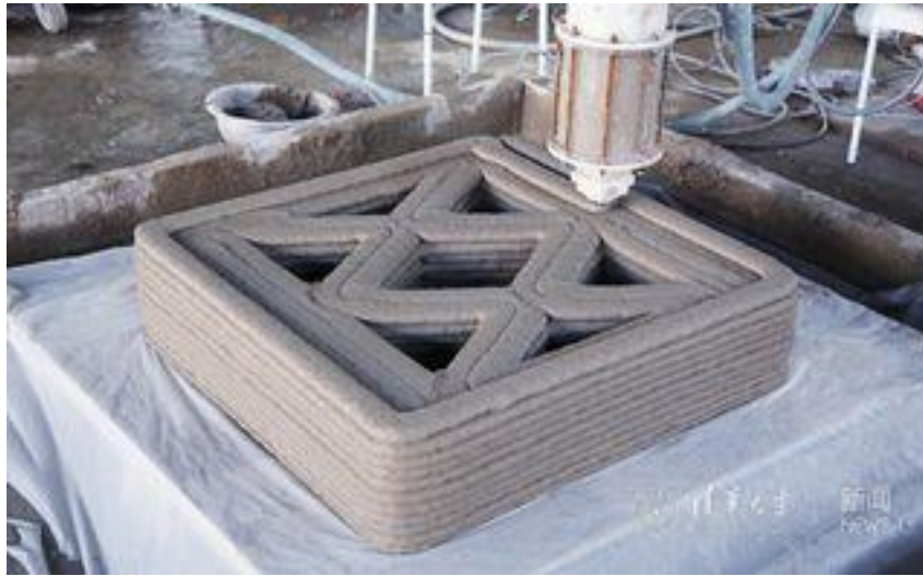
Рисунок 2 – Начальная стадия печати 3д моста в Шанхае
