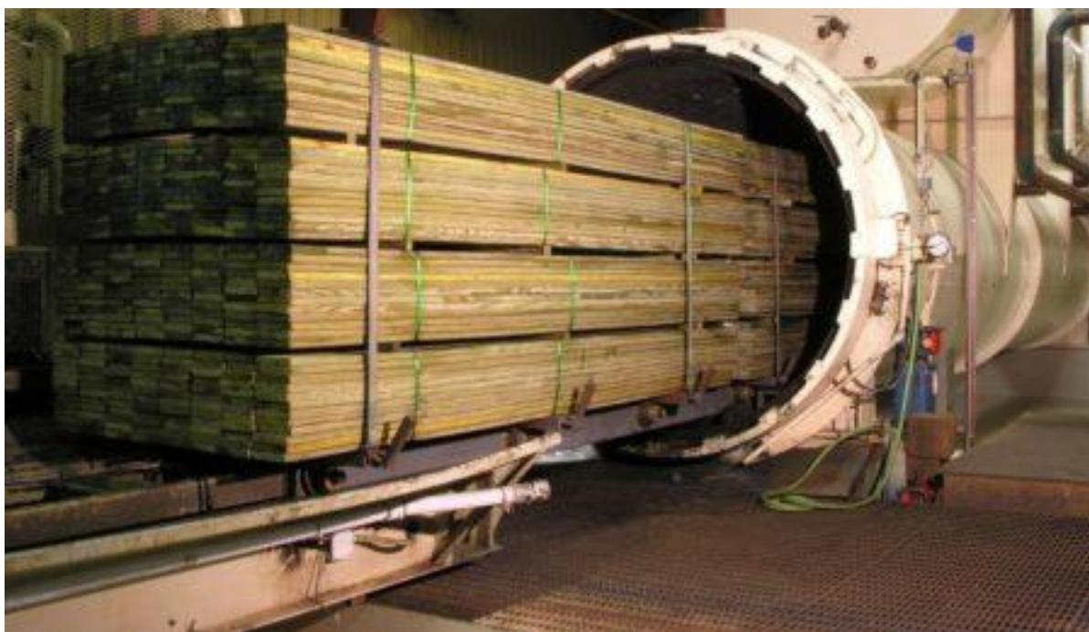
Рисунок 1 – Помещение древесины в вакуумный агрегат
