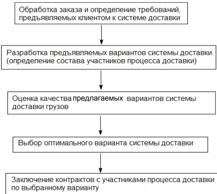
Рис. 2.6. Схема проектирования системы доставки
