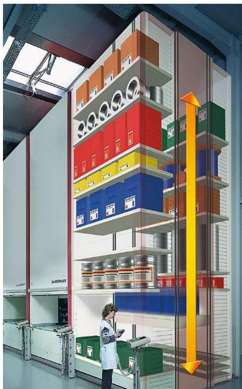
Рисунок 1 – Стеллажная конструкция лифтового типа
