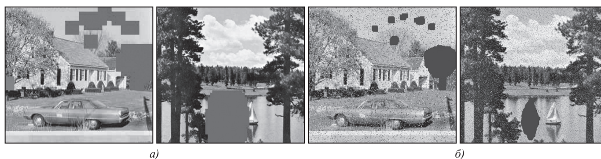
Рис. 2. Результат работы алгоритма при преобразовании графического формата изображения (а) и наличии шума в канале связи (б).
