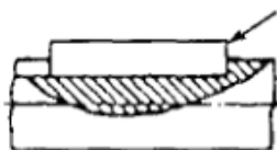
Рис. 43. Нанесение удара при извлечении шпонки
