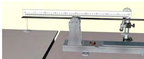
Рис. 6.5. Линейка, установленная на балке
