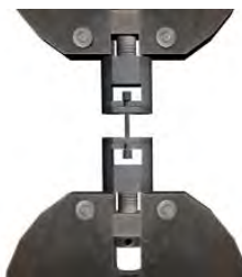
Рис. 2.11. Зажатый между кулачками образец
