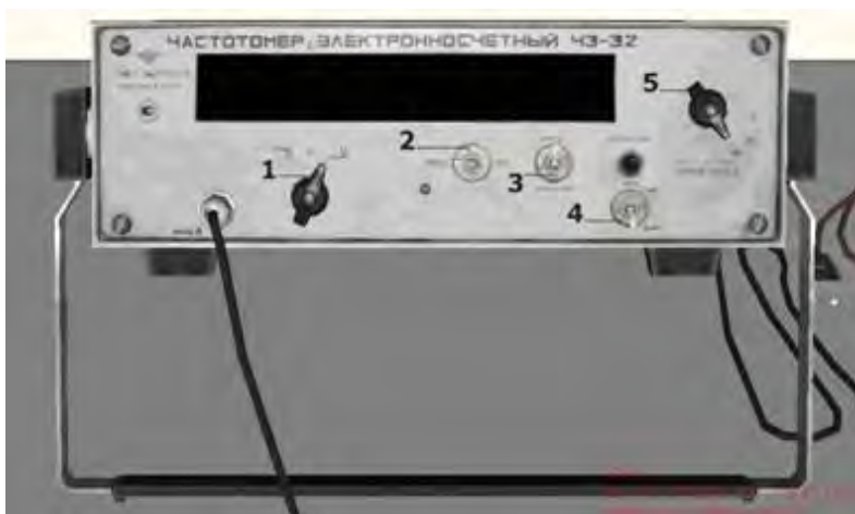
Рис. 8.4. Электронносчетный частотомер ЧЗ-32:
