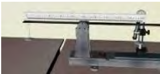
Рис. 7.4. Линейка, установленная на балке
