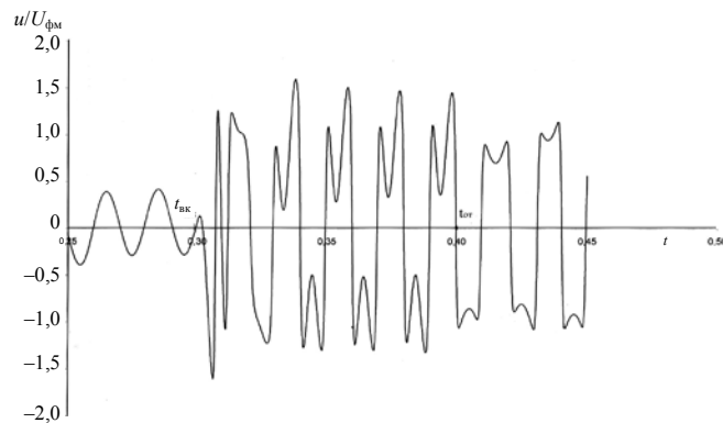
Рис. 7. Расчетная осциллограмма полученного феррорезонансного перенапряжения: t_{\text{от}} – момент отключения e_3(t)
