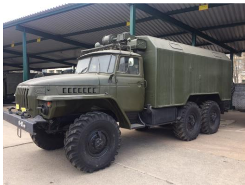
Рис. 2. Передвижная инженерная электростанция ЭД-16 АИ
