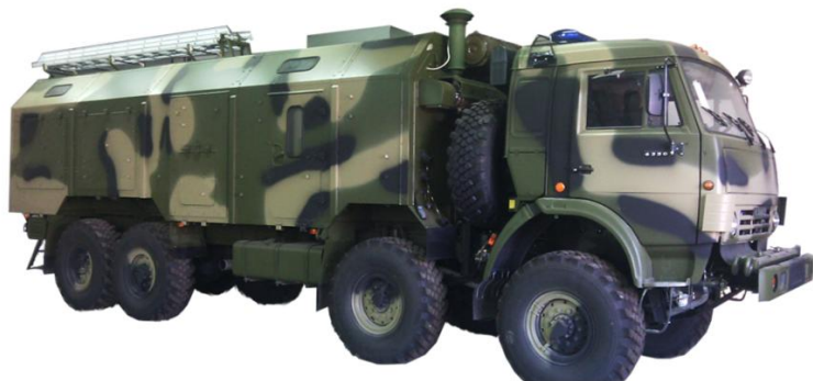
Рис. 3. Электростанция передвижная инженерная ЭД-30 АИ
