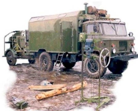
Рис. 1. Инженерная электростанция передвижная ЭСБ-8ИМ
