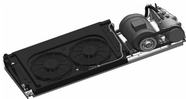
Рис. 1. Пример полной трехмерной твердотельной модели компрессорно-конденсаторного агрегата
