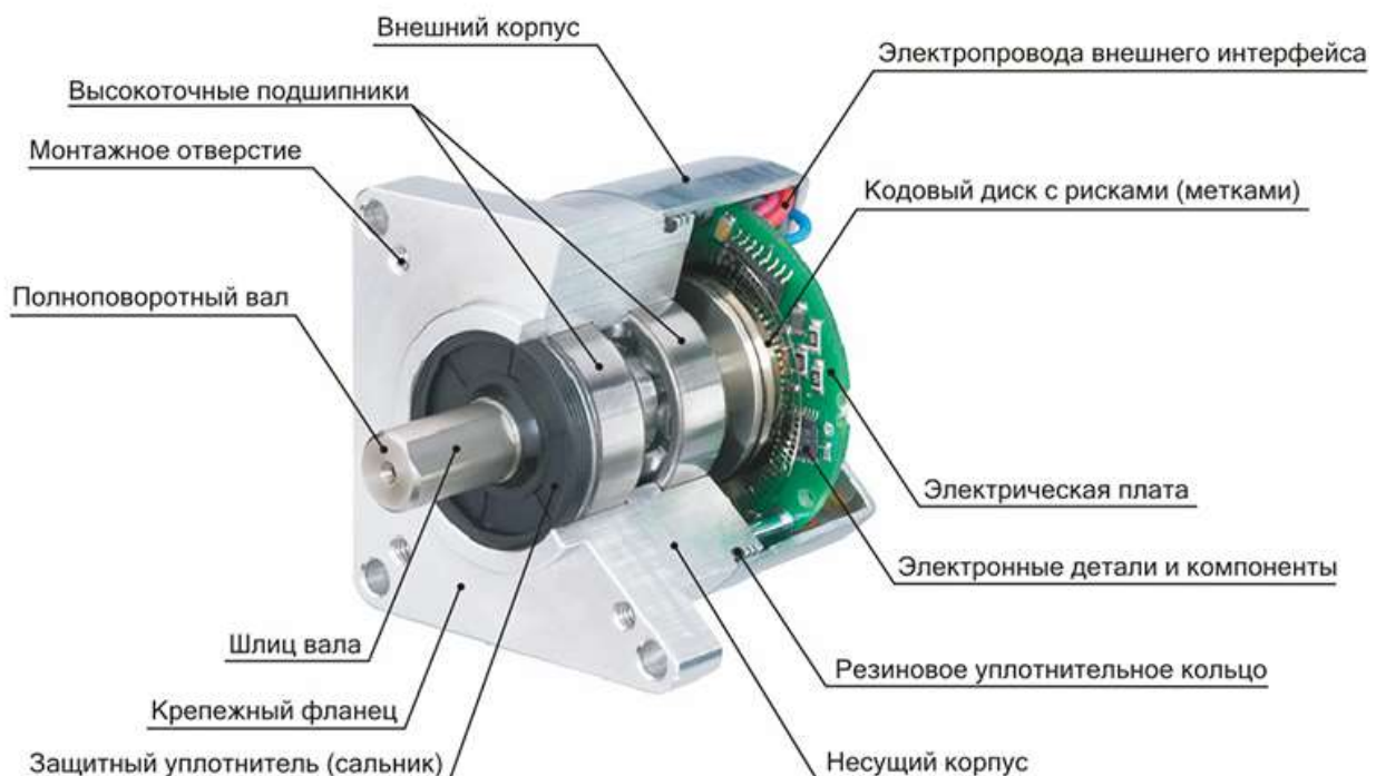
Рисунок 1. Устройство энкодера
